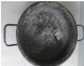
Obr. 9 Ohořelá nerezová pánev se zbytky po hašení
